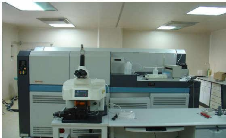
图 2 中国地质科学院矿产资源研究所 Thermo Neptune 型多接收电感耦合等离子体质谱仪 (MC-ICP-MS)
