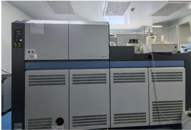
图 1 中国地质科学院矿产资源研究所 Thermo Neptune Plus 型多接收电感耦合等离子体质谱仪 (MC-ICP-MS)
